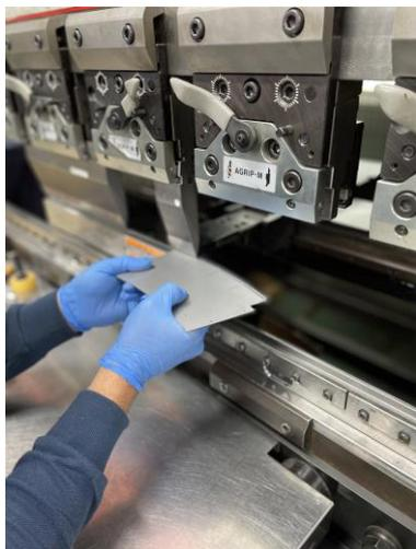
▲ 本体の切り出し、底面の曲げ加工
