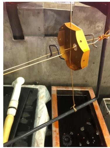
▲ 底面のアルマイト表面処理加工（防錆、着色）
